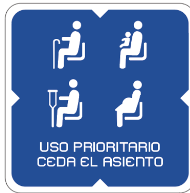
Imagen 16. Señalización visual que se requiere incorporar para la identificación de los asientos designados para personas con movilidad limitada, tamaño 150 mm por 150 mm, colocada sobre ventanilla adyacente.
