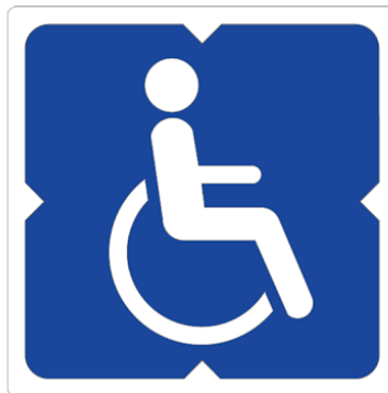
Imagen 16. Señalización visual que se requiere incorporar para la identificación de los asientos designados para personas con movilidad limitada, tamaño 150 mm por 150 mm, colocada sobre ventanilla adyacente.
