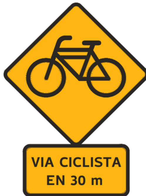
Figura 5.4 .Ejemplo de aplicación de la señal SP-C con la leyenda "VÍA CICLISTA EN XX M". SEMOVI.
