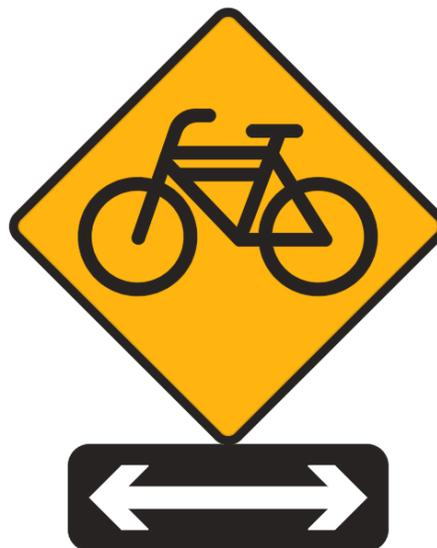
Figura 1.13. Señal SP-39 *Ciclistas* y SR-B *Sentido del tránsito*. SEMOVI.
