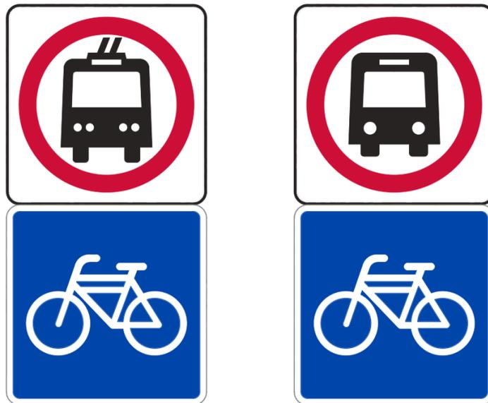
Figura 1.12. Señalamiento vertical múltiple para indicar vía exclusiva de transporte público compartido con vehículos no motorizados (Carril Bus-Bici). SEMOVI.
