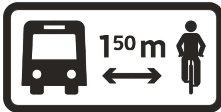
Figura 5.1 .Propuesta de señal SR-C.2 Distancia de rebase. SEMOVI.
