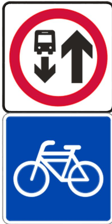
Figura 5.5 .Conjunto de señales SR-14d y SIS-93 para carriles Bus-Bici en contraflujo. (SEMOVI 2024)
