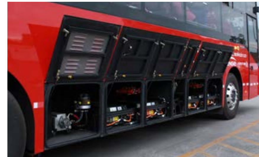
Sistema de batería Metrobús Eléctrico
