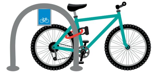
No importa donde te estaciones, sujeta la cadena rodeando tres elementos: el tubo del biciestacionamiento, el cuadro y la llanta trasera.
