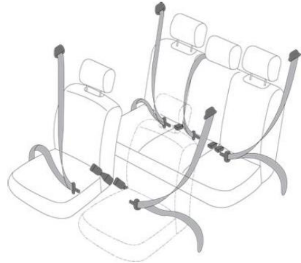
Esquema 2. Cinturones de seguridad de 3 puntos para todos los pasajeros.
