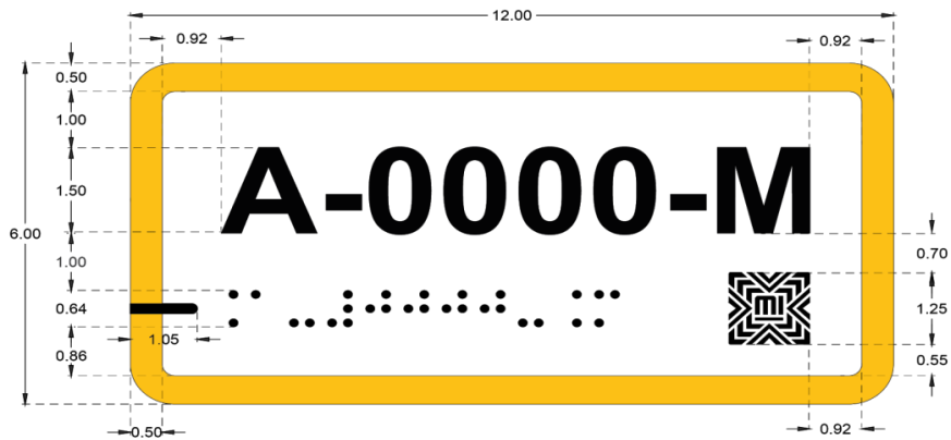
Esquema 6. Placa informativa de matrícula del vehículo (señal tacto-visual con sistema Braille).
